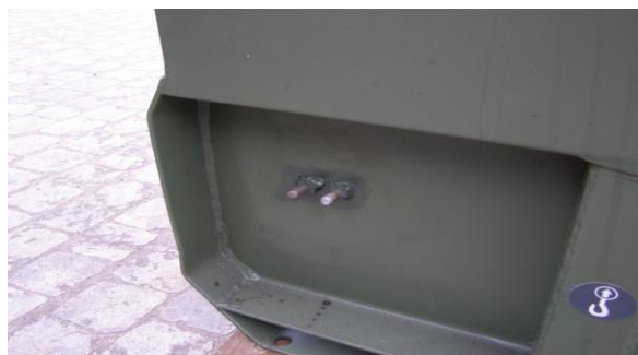
Rys. 8. Zaciski ochronne za blisko siebie uniemożliwiają zakręcenie śrub
