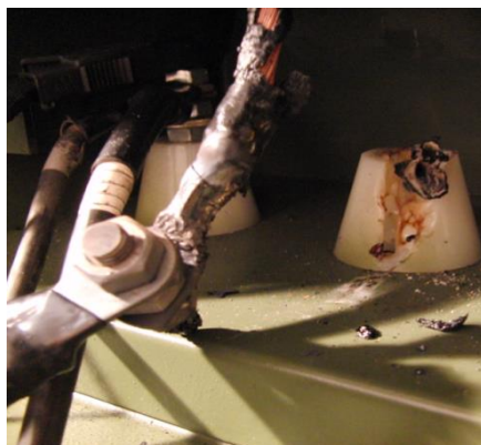
Rys. 13. Stopienie się izolatora z powodu odkręcenia się przewodu od prądnicy podczas próby pracy ciągłej (48 h)
