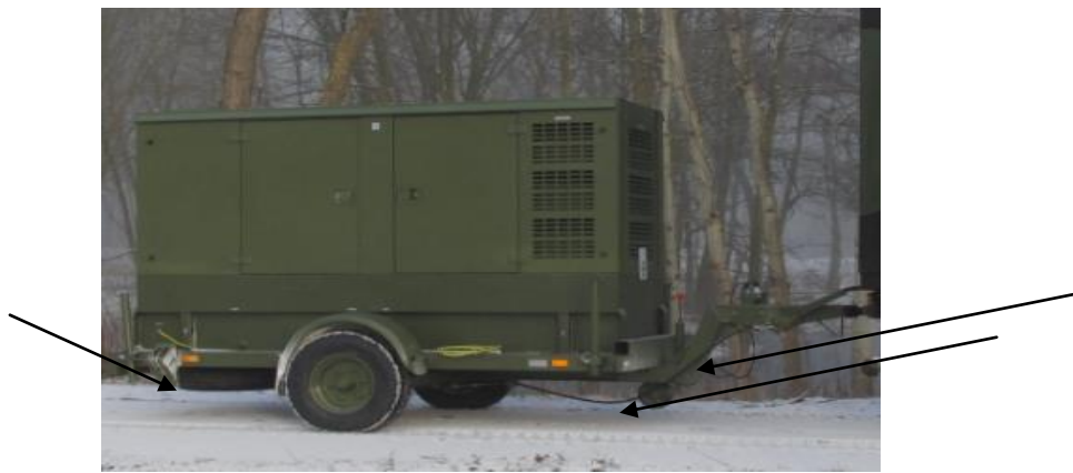
Rys. 11. Mały prześwit, uniemożliwiający poruszanie się w terenie lekko pofałdowanym.
