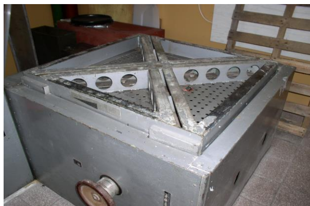
Rys. 2. Maszyna wytrzymałościowa – system wibracyjny
