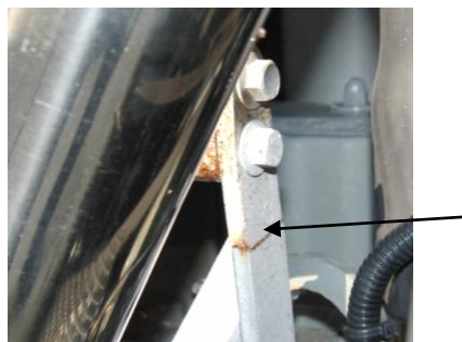
Rys. 17. Pęknięty i skorodowany wspornik układu wydechowego po badaniach wilgotności i pracy ciągłej
