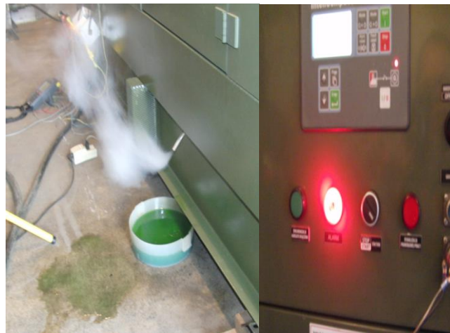
Rys. 18. Awaryjne wyłączenia zespołu na skutek przegrzania zespołu podczas badań w podwyższonych temperaturach otoczenia
