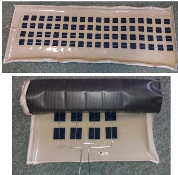
Rys. 16. Prototyp elastycznego pokrycia fotowoltaicznego: wersja rozwinięta i zrolowana
