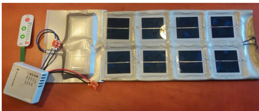
Rys. 19. Prototyp grupy ośmiu ogniw fotowoltaicznych wraz z układem gromadzenia energii
