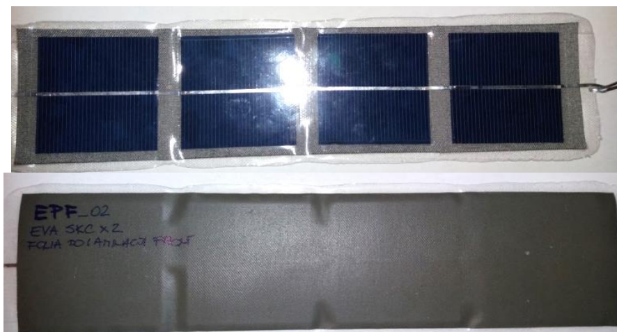
Rys. 7. Próbkę EPF_02 – przedstawiono obie strony pokrycia
