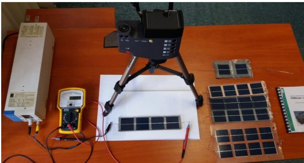
Rys. 12. Stanowisko do badań ogniw słonecznych z wykorzystaniem kamery termowizyjnej
