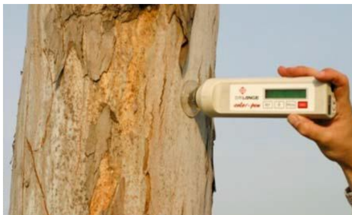
Rys. 4. Wykorzystanie kolorymetru do akwizycji danych kolorystycznych w terenie
