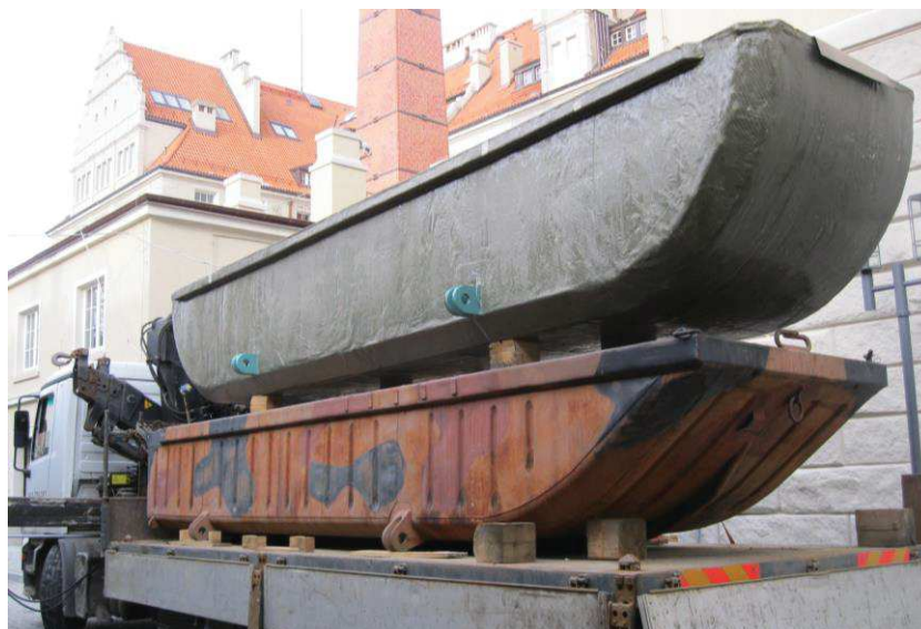
Rys. 5. Widok dwóch pływaków, pp-64 u dołu oraz całkowicie kompozytowy prototyp u góry
