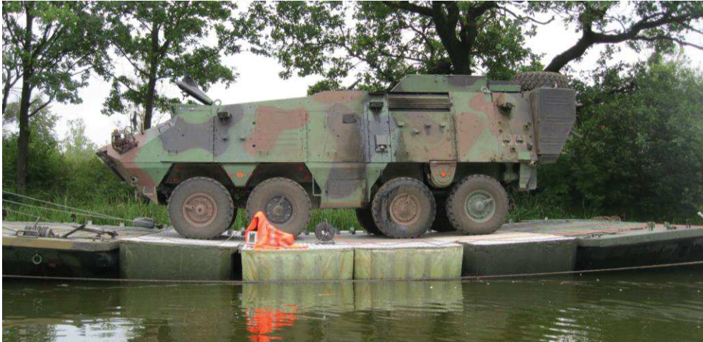
Rys. 9. Próba obciążenia pojazdem kołowym
