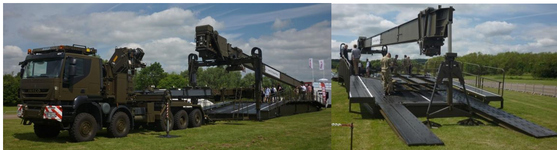
Rys. 5. Przęsło „szwajcarskiej” wersji mostu DSB z chodnikami i poręczami z pojazdem układającym na podwoziu IVECO Trakker 10×8
