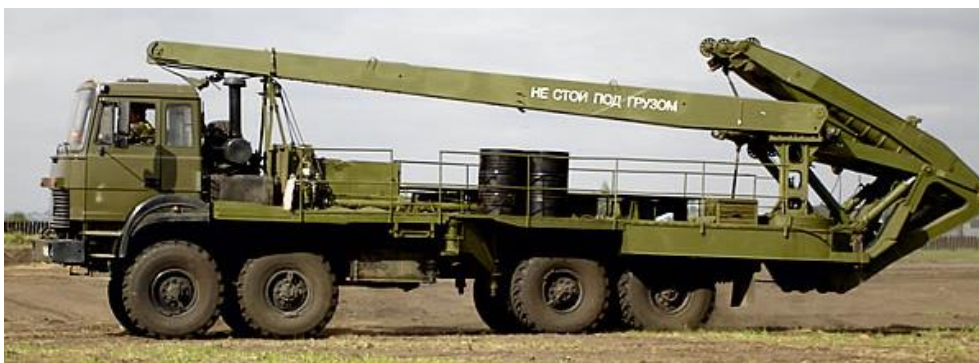
Rys. 9. Pojazd układacz (MCM) z zestawu mosty MMK [22]
