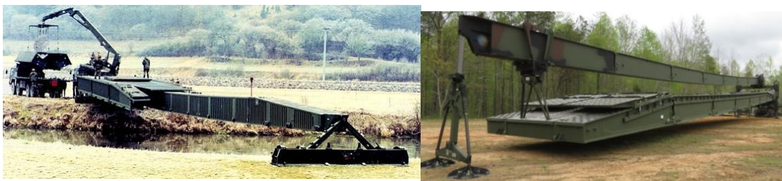
Rys. 11. Różnica w wykorzystaniu przęseł pomocniczych, po lewej FFB i po prawej DSB
