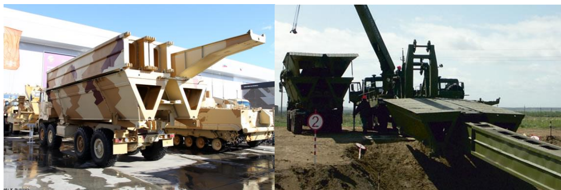
Rys. 10. Widok segmentów mostu i przęsła pomocniczego w położeniu transportowym oraz montaż segmentów przęsła MMK na przęsło pomocniczym [20]
